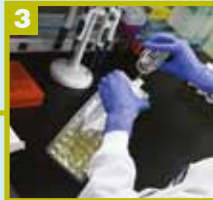
3 Adicionar 2 gotas de solução anti-espuma ao frasco. Verter a amostra na bandeja Quanti-Tray* ou Quanti-Tray*2000
