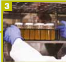
3 Incubar o frasco durante 24 - 48 horas a 38 °C ± 0,5 °C
