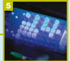
5 Ler os resultados sob luz ultravioleta. Contar os poços com fluorescência azul e consultar a tabela de NMP
