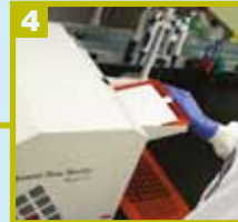
4 Selar a bandeja com o selador Quanti-Tray* e incubar durante 24-48 horas a 38 °C ± 0,5 °C
