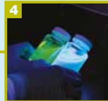
4 Ler os resultados sob luz ultravioleta. Fluorescência azul indica a presença de P. aeruginosa
